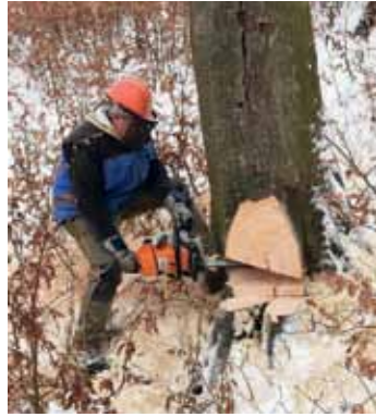
Péntek László a hajkolás után a fa közepébe beszúr a felrepedés ellen
